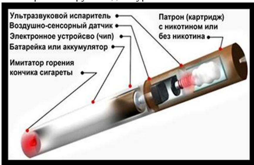
Конструкция электронного парогенератора проста и состоит из двух основных частей:
